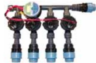
**Batteriebetriebenes Hybrid-Steuergerät, elektronisch, 3 Programme mit je 4 Startzeiten, Anschluß für Hauptventil, arbeitet mit Impuls-Magnetspulen (Latching-Solenoids), wetterfestes Gehäuse, Batterien (6 x AA) nicht im Lieferumfang**
