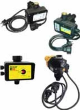
**Druckschalter** zum automatischen Betrieb von Pumpen. Einschaltdruck 1,5bar, mit 1,5 m Kabel, Schukostecker und Kupplung mit 0,4m Kabel, mit Trockenlaufschutz
