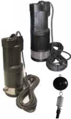
**Unterwasserpumpe/ Behälterpumpe mit 15m Netzkabel** und Schukostecker, integrierte Schalteinheit, zur Förderung aus Regentanks und Zisternen. Die integrierte Schalteinheit steuert die Ein- und Ausschaltung der Pumpe. Ein Trockenlaufschutz ist integriert sowie ein automatischer Reset. Spannung 230V/50Hz, Ausgang 1" Innengewinde, Volumenstrom/Fließdruck: 1,2m³/h/4,0bar; 1,8m³/h/3,7bar
