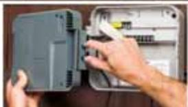
**Hunter HPC Umrüst-Kit mit Touchscreen-Oberfläche, Ermöglicht eine Umrüstung der Pro-C Steuergeräte PC-401i und PC-401 zum HydraWise-Steuergerät. Zugang über WLAN oder direkt am Gerät, 36 Startzeiten pro Tag, 36 Programme, maximale Stationslaufzeit 24 Stunden,**
