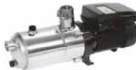
Vollautomatisches Hauswasserwerk Typ **Tecnopres**, besonders geeignet für Beregnungsanlagen, automatisches Ein-/Ausschalten der Pumpe, Trockenlaufschutz, automatischer Reset nach Trockenlauf, Anschluss für Manometer, Rückschlagventil, kompl. montiert und einsatzbereit. Förderstrom (Förderhöhe):
