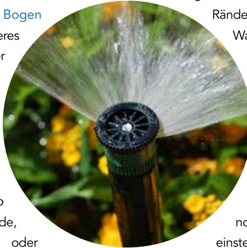
Es geht um optimal abgegrenzte, saubere Ränder. Diese Düsen bilden größere Wassertropfen und verhindern außerdem die Verteilung des Wasserstrahls durch den Wind. Aufgrund des einheitlichen Niederschlagswerts können sie selbst bei unterschiedlichen Radien gruppiert werden. Und Dank des neuen Aufsatzes lassen sich die Düsen jetzt noch einfacher einstellen. Sie sind einstellbar auf jeden Winkel zwischen 0° und 360°. Sie benötigen keine Werkzeuge.
