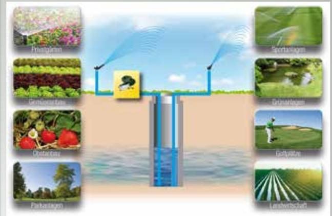
Gekennzeichnet durch die Verwendung einer selbstansaugenden Elektropumpe EUROINOX, die auch bei Vorhandensein von Luftblasen und Gasen funktioniert. Unbedingt erforderlich, wenn man Brunnenwasser fördert und Ansaugschwierigkeiten vorhanden sind. Die mehrstufigen Elektrokreiselpumpen EUROINOX sind besonders geeignet für geräuscharmen Betrieb und Ansaugung über dem Wasserspiegel.
