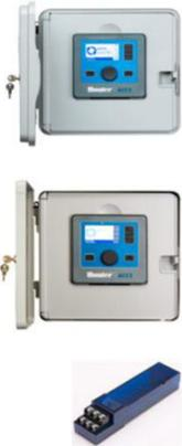
Hunter ACC2 Steuergerät, elektronisch, mit Anschluss für Echtzeit-Durchflusskontrolle, 6 Durchfluss-Zonen, modular erweiterbar auf max. 54 Stationen, bis 10 Startzeiten pro Programm Tag, 32 Programme, Wasserbudget 0 bis 300%, Anschluss für Pumpenstart-Relais, wetterfestes Gehäuse (abschließbar), eingebauter Trafo (230/24 Volt 50 Hz), SmartPort-Anschluss
