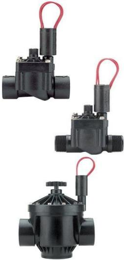
Magnetsteuerventile aus hochwertigem Kunststoff "Serie PGV " Druckbereich: 1,50 bis 10,0 bar, einschl. Standard-Magnetspule **24Volt 50Hz**
