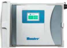
Hunter HCC mit Touchscreen-Oberfläche, modular erweiterbar auf max. 38 (HCC-800-PL) bzw. 54 Stationen (HCC-800-M), 36 Startzeiten pro Tag, 36 Programme, maximale Stationslaufzeit 24 Stunden, Anschluss für Pumpenstart-Relais, wetterfestes Gehäuse (abschließbar), eingebauter Trafo (230/24 Volt 50 Hz), SmartPort-Anschluss für ROAM-Kit
