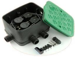
Vormontierte MICRO-Ventilstation mit 4 Magnetventilen, Ventilboxdeckel mit O-Ring abgedichtet, Durchfluss: bis zu 2,1m<sup>3</sup>/h bei 3,0bar
