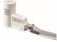
Regenabschaltgerät "Rain-Click", <b>sofortige Quick-Response-Regenabschaltung und Frostabschaltung</b><br>bei 3°C, einschl. Anschlusskabel (Länge: 7,6m)<br>ÖFFNER (für alle HUNTER-Steuergeräte) | Rain-Click           | 1  | 61,00   |
